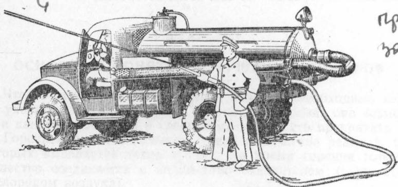
Рис. 75. Автожигеразбрасыватель АНЖ-2, приспособленный для тушения пожара.
